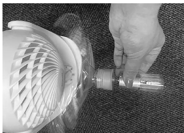
PETボトル風車を回し電球点灯を確認
