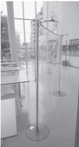
図4 シールド吊下げ用の台座と支柱
